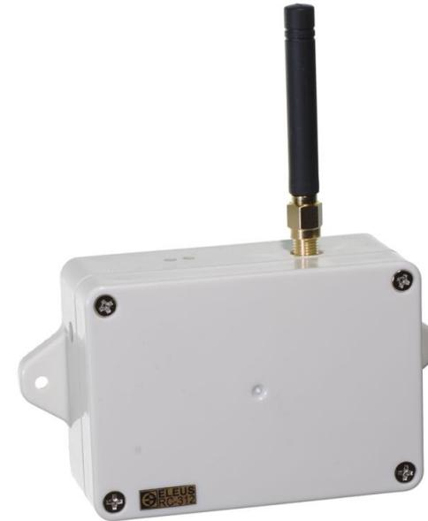
По умолчанию параметры модуля запрограммированы следующим образом: T1>31, T2-, T3-, T4-, TK>29, DK=30m, DT=30m, P=0h. Это можно проверить, отправив SMS с текстом S на модуль. Необходимо обязательно перепрограммировать эти параметры в соответствии с запросами пользователя.
